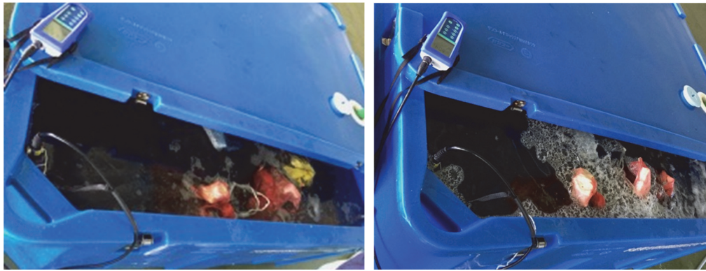
写真2 活魚タンク内の水温及びDO測定の様子（左：エアレーションなし、右：エアレーションあり）
