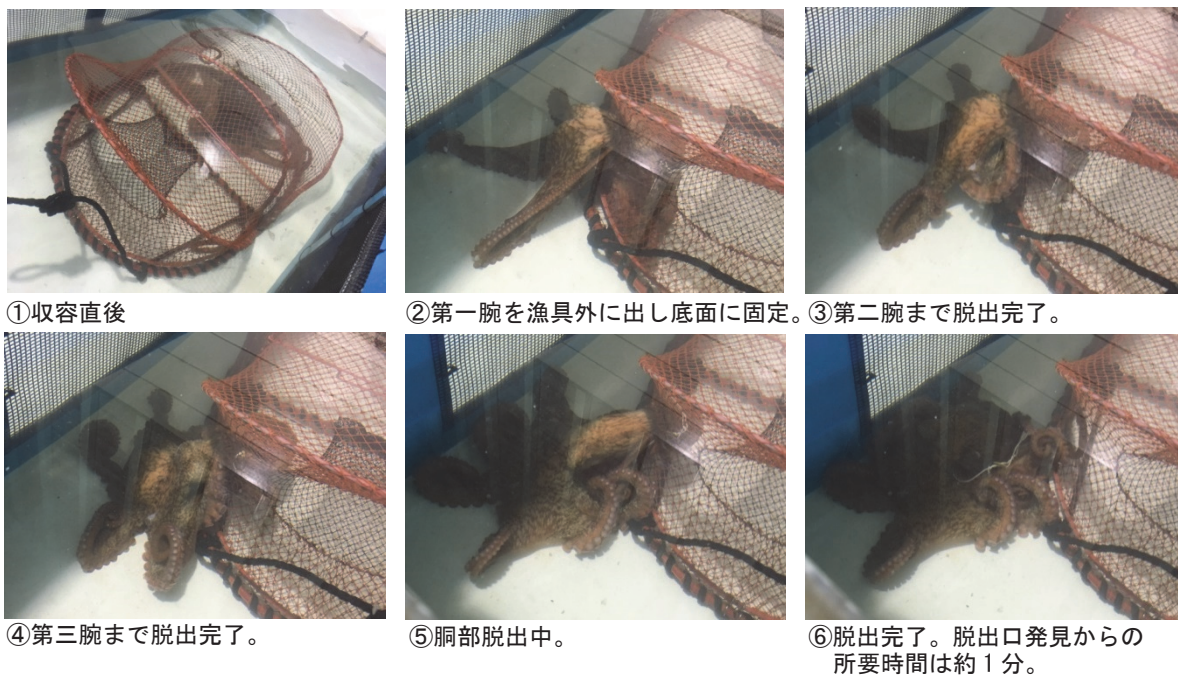
写真1 水槽実験におけるミズダコ小型個体（体重1.85kg）の脱出過程
